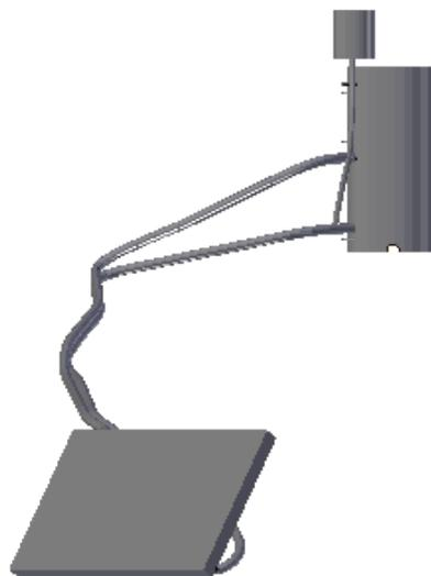
J'ai choisi un kit thermosiphon chez solaire-diffusion composé d'un ballon TWS200 double échangeur, d'un panneau horizontal LM tinox 1041\*1980, de 10m de bitube inox annelés isolés diamètre 20mm, d'un vase d'expansion de 18 litres et de toutes les pièces de raccordement et organes de sécurité nécessaires.
